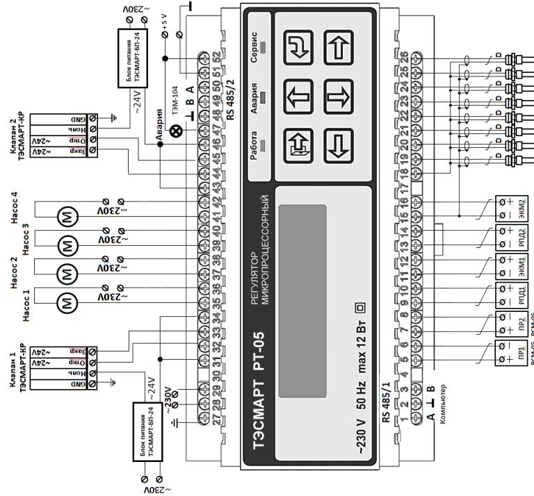
**Примечание:** при использовании насоса с током потребления менее 1А коммутация цепей питания может производиться без использования внешнего реле.
