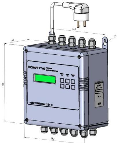
Максимальные габаритные размеры корпуса регулятора составляют 182x228x94мм.
