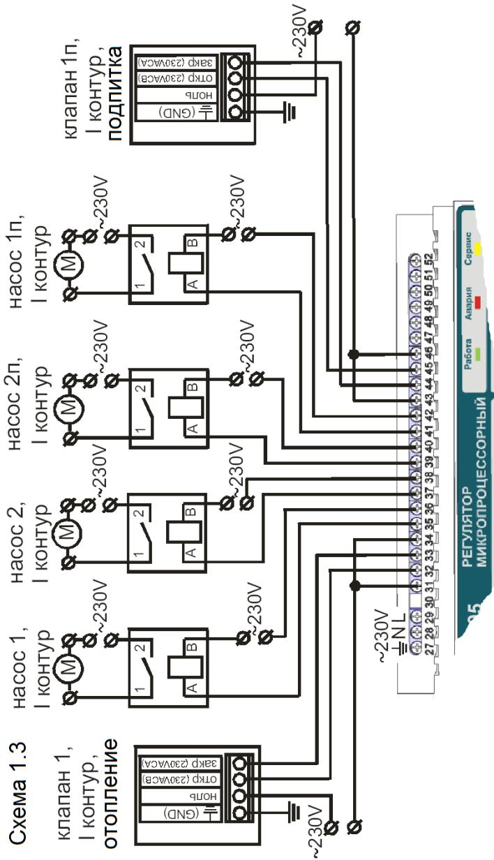
**Примечание:** при использовании насоса с током потребления более 1А коммутация цепей питания должна производиться внешним реле.
