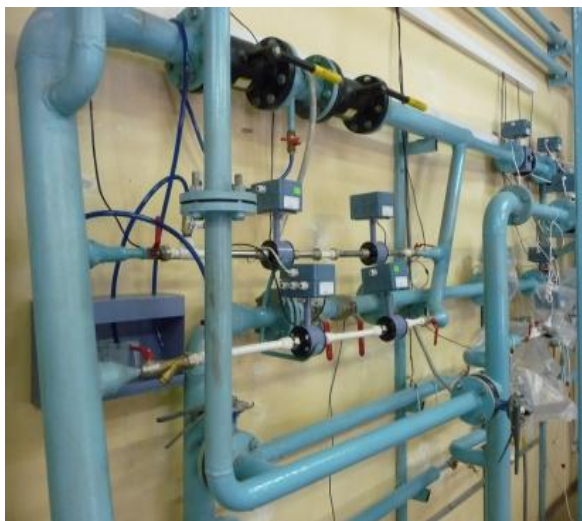
Рис.4.1.4 Узел образцовых расходомеров (УЭР)
