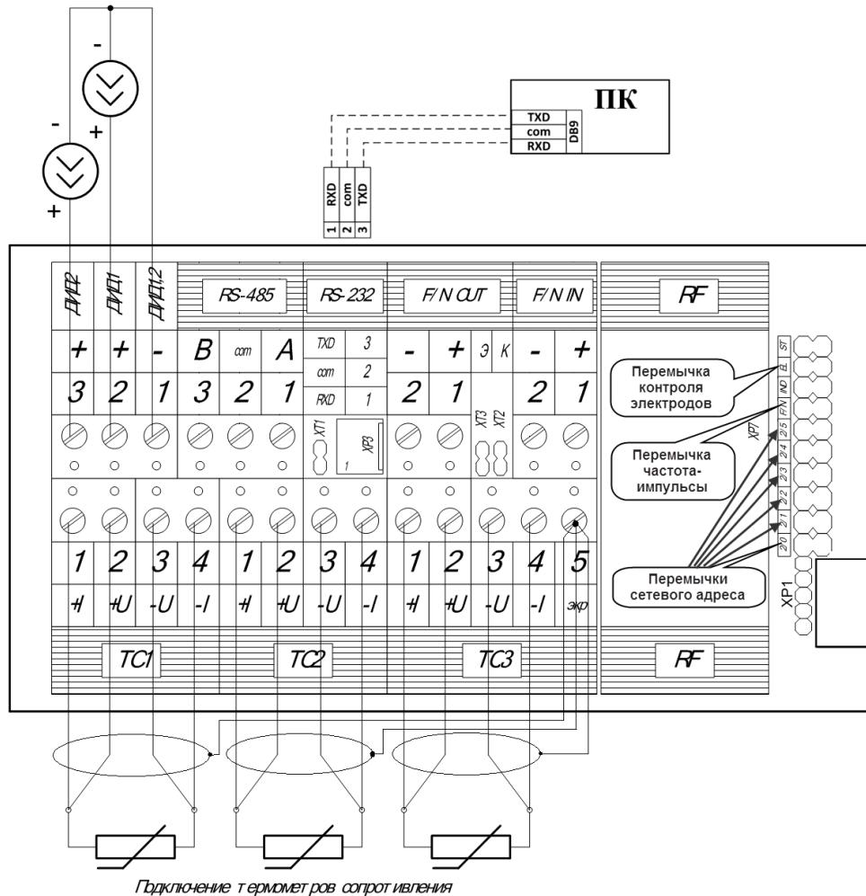
Рисунок 8.12 Схема подключения расходомера PCM-05.05(ТЭСМАРТ-П), PCM-05.05(ТЭСМАРТ-ПА), для расходомера PCM-05.05(ТЭСМАРТ-Э) датчик давления ДИД2, а также термометры ТС2 и ТС3 не подключаются.
