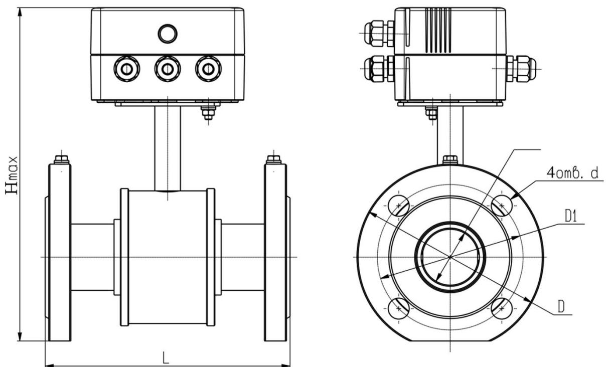
Рисунок Б.4 Габаритные и установочные размеры расходомеров РСМ-05.05(ТЭСМАРТ-II), РСМ-05.05(ТЭСМАРТ-ПА), РСМ-05.05(ТЭСМАРТ-Э) с ПМ.07.02 и ПРПН
