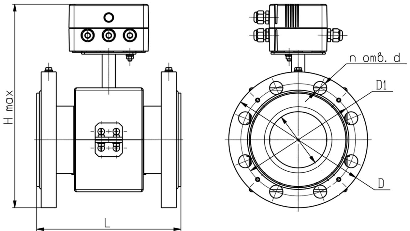
Рисунок Б.1 Габаритные и установочные размеры PCM-05.05 (ТЭСМАРТ-П), PCM-05.05(ТЭСМАРТ-ПА), PCM-05.05(ТЭСМАРТ-Э) с ПМ.07.02 и ПРП
