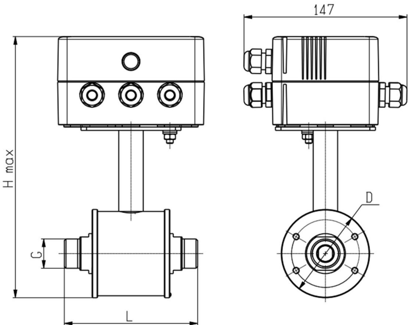
Рисунок Б.3 Габаритные и установочные размеры расходомеров PCM-05.05(ТЭСМАРТ-П), PCM-05.05(ТЭСМАРТ-ПА), PCM-05.05(ТЭСМАРТ-Э) с ПМ.07.02 и ПРПН/Р
