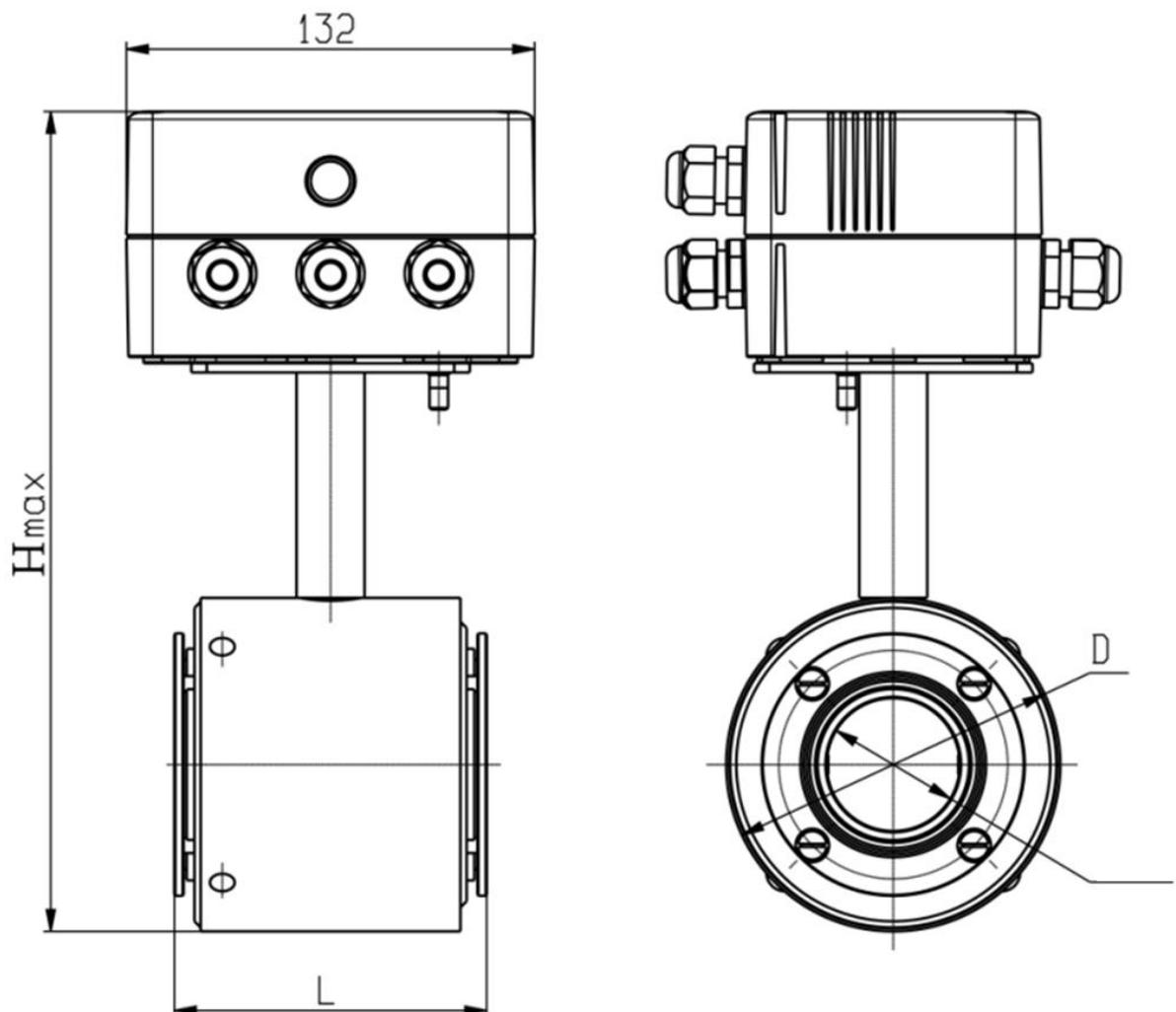
Рисунок Б.2 Габаритные и установочные размеры расходомеров PCM-05.05(ТЭСМАРТ-П), PCM-05.05(ТЭСМАРТ-ПА), PCM-05.05(ТЭСМАРТ-Э) с ПМ.07.02 и ПРПМ
