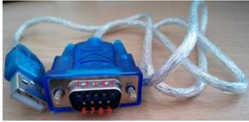
В конвертере использована микросхема WinChipHead CH340, обеспечивающая интерфейс Full speed USB 2.0/USB 1.1. Со стороны RS-232 - все управляющие сигналы: DSR, DTR, RTS, CTS, RI, DCD, а также основные сигналы RXD и TXD.
