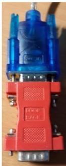
С помощью LoopBack запустим и попробуем программку IC Serial Port Test.
