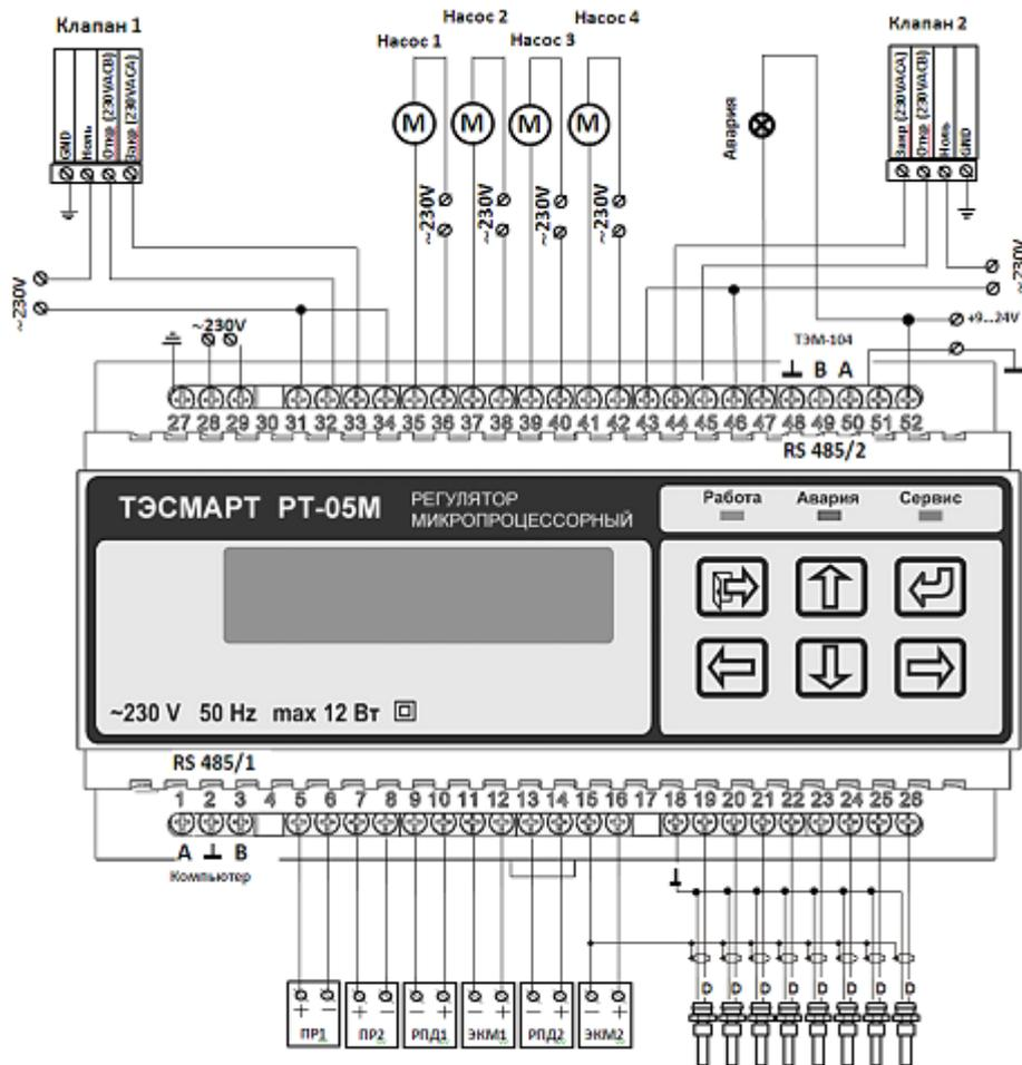
На схеме ПР1, ПР2 - датчики, преобразователи расхода в частоту, РПД, ЭКМ - датчики давления.
