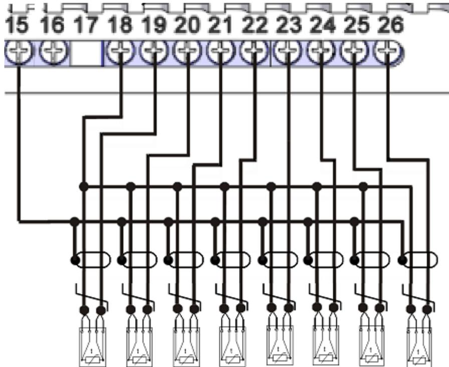
Для подключения датчиков используют кабель «витая пара в экране» КММ, ПВХС, ШВЧИ или аналогичные кабели с большим сечением жил. Экраны кабелей можно подключать к 6, 8, 9, 11, 13, 15 контактам клеммника.
