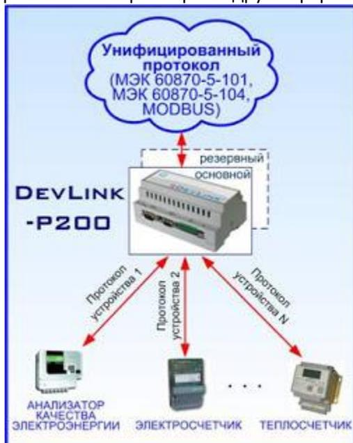
В качестве примера можно привести контроллеры [DevLink](#) ООО «ЭнергоКруг». В частности, конвертеры протоколов DevLink-P200 предназначены для преобразования «на лету» различных протоколов цифровых устройств в один или несколько стандартов с возможностью обработки получаемых от теплосчетчиков данных.
