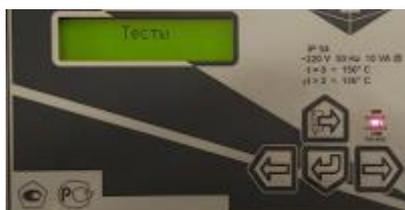
В этом режиме можно посмотреть величину сопротивления ТСП, амплитуду полезного сигнала по расходу на входах АЦП, ток датчиков давления.
