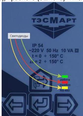
Тривиальная ситуация - на дисплее ничего нет и ни один светодиод не светится - нет питания 220 В или сгорел предохранитель (стоит внутри теплосчетчика справа внизу). Более сложная ситуация - дисплей чист, а зеленый и/или красный светодиоды светятся/мигают. Если повторное включение дает тот же результат, то прибор в ремонт.
