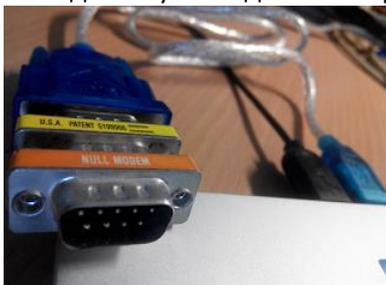
У некоторых экземпляров конвертера при подключении адаптера АД-01ПУ иногда снижается яркость индикатора ЖКИ. Проблема решается запайкой резистора 2,7 кОм в разрыв второго вывода разъема RS232.
