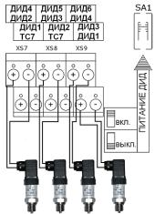
Подключение 4-х датчиков давления (на рисунке - ДИД1, ДИД2, ДИД3, ДИД4) и термометра (Т7) выполняется в соответствии с нижней строкой шелкографической надписи под клеммной колодкой. Однако такая схема подключения возможна только по дополнительному заказу. В иных случаях необходимо будет использовать более дорогостоящую схему подключения от внешнего источника питания.
