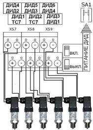
Подключение 6-ти датчиков давления (на рисунке - ДИД1, ДИД2, ДИД3, ДИД4, ДИД5, ДИД6) выполняется в соответствии с верхней строкой шелкографической надписи под клеммной колодкой. Как и для ТЭМ-106-1, ТЭСМА-106-1 такая схема подключения возможна только по дополнительному заказу. В иных случаях необходимо будет использовать более дорогостоящую схему подключения от внешнего источника питания.
