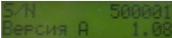
Версия А - модуль АЦП установлен, используются термосопротивления.
