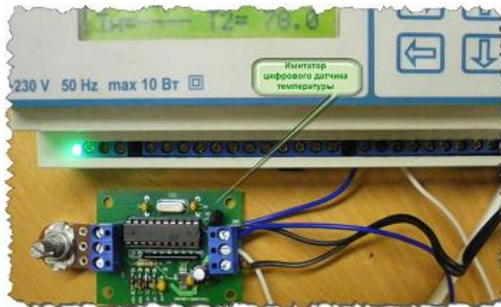
С помощью имитатора можно имитировать температуру в диапазоне  $+120^{\circ}\text{C}$  до  $-70^{\circ}\text{C}$ . Величина температуры задается с помощью переменного резистора. Имитатор требует дополнительно питание от  $+5\text{В}$ . Хотя при подключении в лабораторных условиях была замечена работа имитатора без источника питания, за счет входных токов регулятора АРТ-05.
