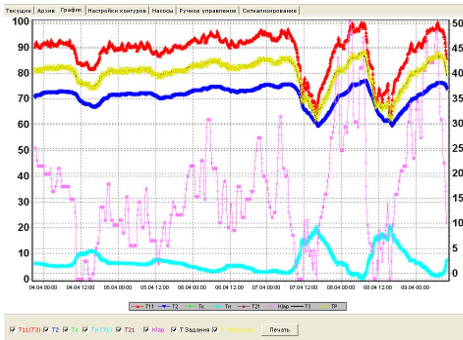
По горизонтали - время, 5 минут отсчет. На оси отображается дата, время. Левая ордината размечена от 0 до 100 и отображает процент открытия клапана - график с синевым цветом. Правая ордината размечена в С.
